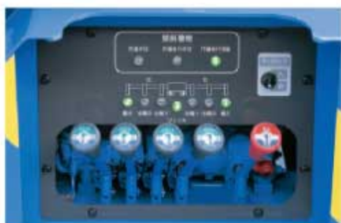
アウトリガ操作部とアウトリガインジケータ(写真:BT-110)
